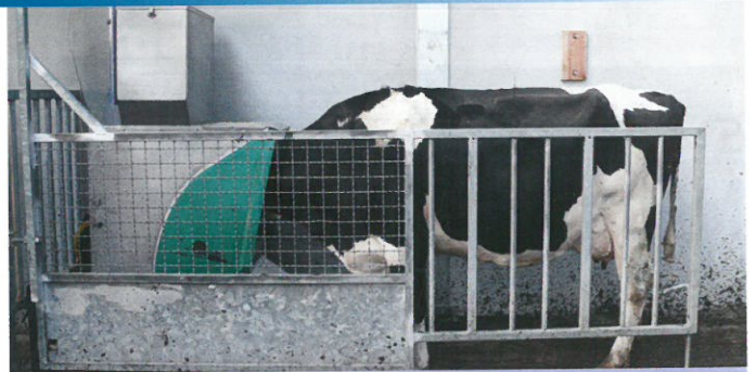
De krachtvoederautomat GreenFeed, C-Lock meet de CH 4 - en CO 2 -emissies van een individuele koe wanneer ze een portie krachtvoeder komt halen.
