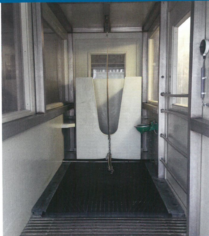
ILVO heeft 6 individuele gasuitwisselingskamers (GUK's) voor het meten van CH 4 - en CO 2 -emissies.
